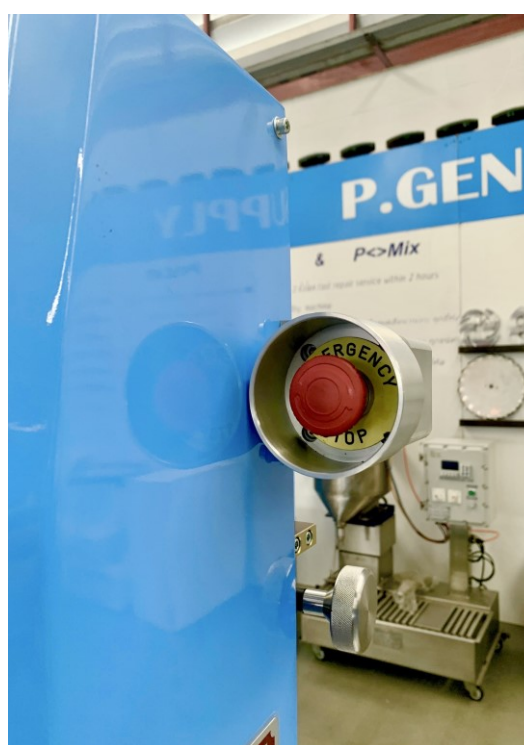
ปุ่ม Emergency Stop
